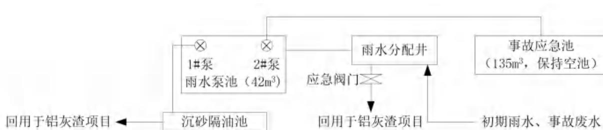
图 7-2 二期厂区初期雨水及事故废水收集系统示意图
