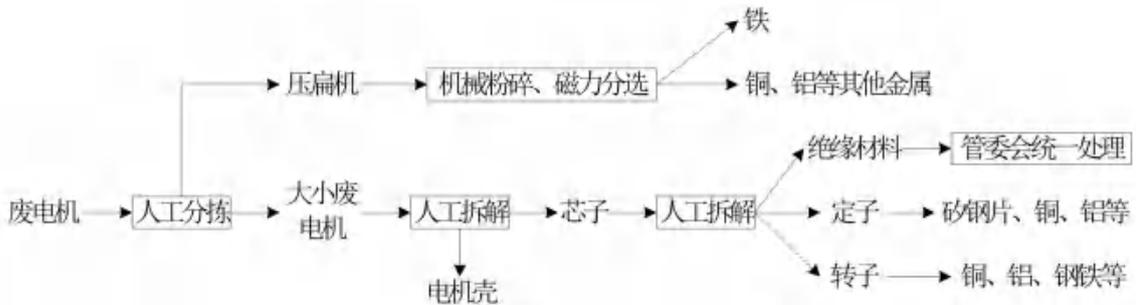
图 2.3-2 废电机拆解工艺流程
